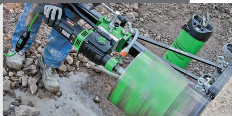
BST 352 V: carrello montato su 4 sfere speciali
